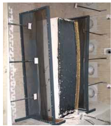
Armadio CHEMISAFE FIRE dopo la prova di resistenza al fuoco.
