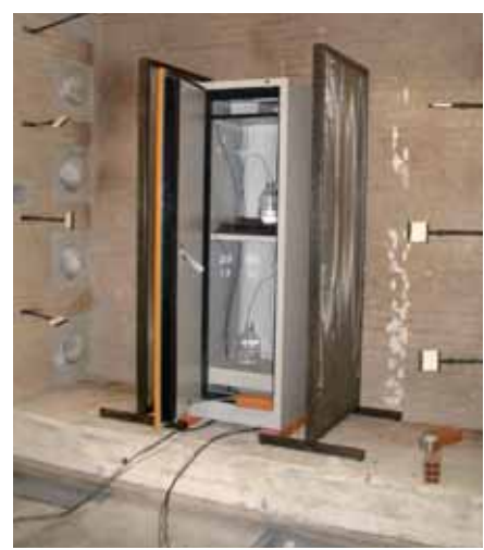
Armadio CHEMISAFE FIRE prima della prova di resistenza al fuoco.
